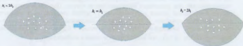
Рис. 14. Сечение линзообразной КТ. Перераспределение частиц при изменении высоты КТ.
